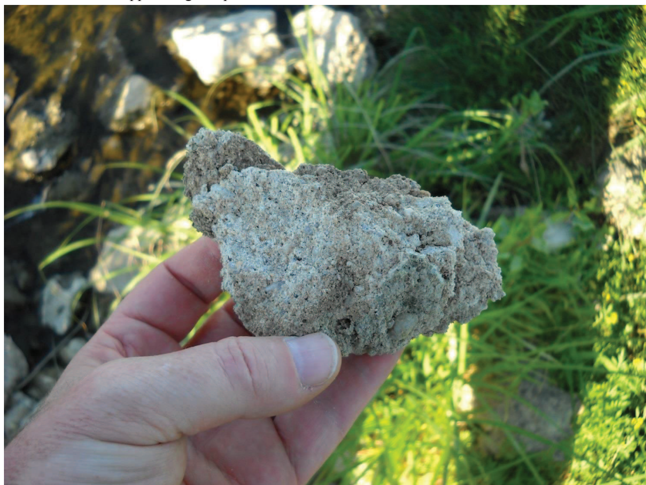
Appareillage du parement et mortier blanc à la chaux et au sable de Loire
